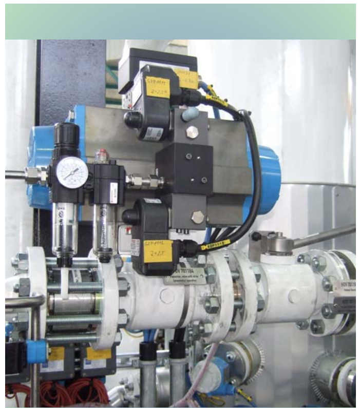
ASC Kugelhahn ATEX mit SIL2 Steuerung ASC ball valve ATEX with coltrol unit SIL2
